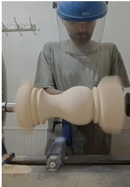
شکل ۵: تکنیک بیرون‌تراشی در خراطی (نگارنده)
