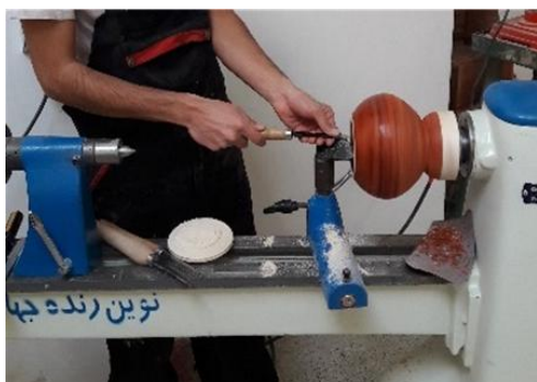
شکل ۷: تکنیک داخل‌تراشی در خراطی (نگارنده)
