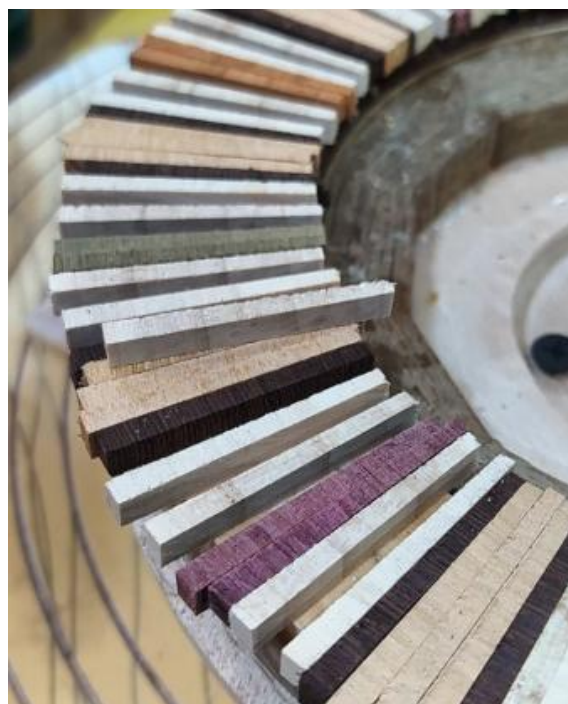
شکل ۱۳: برش قطعات با زاویه یک درجه (آرشیو استاد رحمانی)
